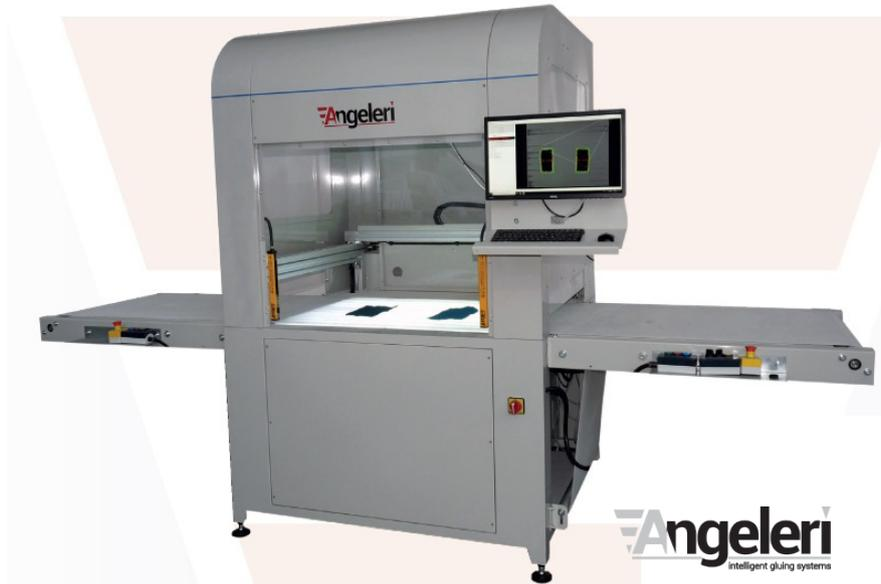
Encoladora automática de 3 ejes con visión artificial y banda de introducción, equipada de doble pistola, una para encolado periférico y la otra para encolado completo sobre toda la superficie de la pieza. Software de control que genera en automático las trayectorias de adhesivo. Durante la aplicación un sensor verifica la cantidad de adhesivo depositado en cada pieza individual y muestra un informe en la interfaz de usuario.
